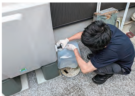
市民宅の雨水タンクから集水する様子。
